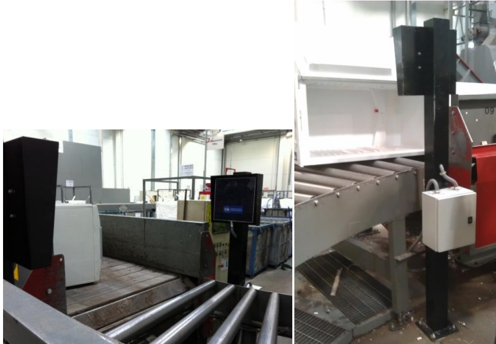
Figura 9: Lector automático RFID Arc-reading system en FANE-EcoIntegra
